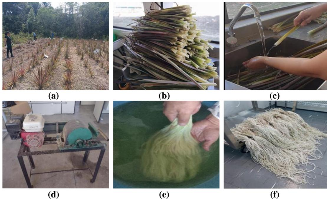
Colheita (a), folhas colhidas (b), lavagem das folhas (c), máquina desfibadora (d), lavagem das fibras (e), fibras secas após 48 a 72 horas de sol (f).
